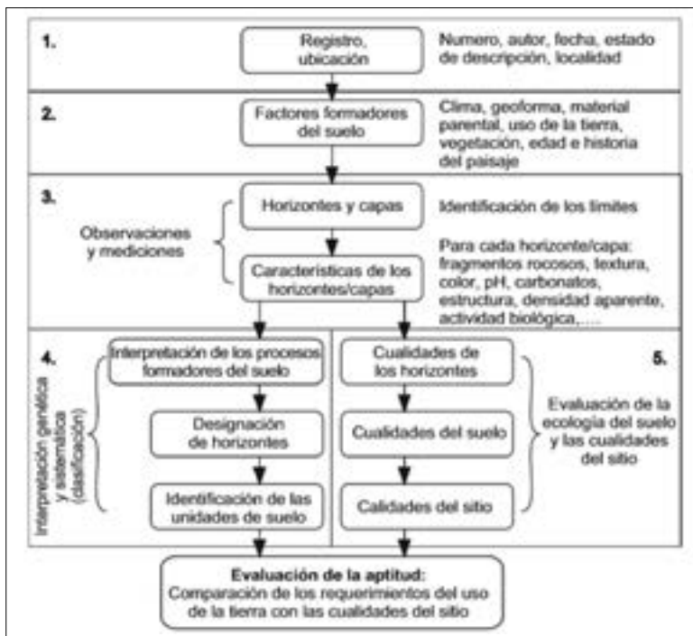
Figura 1. Proceso de descripción del suelo, clasificación, calidad del sitio y evaluación de la aptitud. Fuente: FAO (2009, p. 1).
