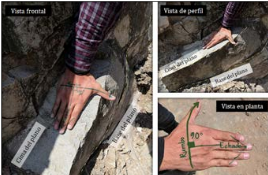
Figura 3. Homologación de la mano derecha con el plano que se desea medir (en este caso es un estrato), mediante el método de la RMD. La orientación en la que se encuentra el dedo pulgar es la misma en la que se debe colocar la pínula mayor, para tomar el dato del rumbo con la brújula tipo Brunton. Fuente: elaboración propia.
