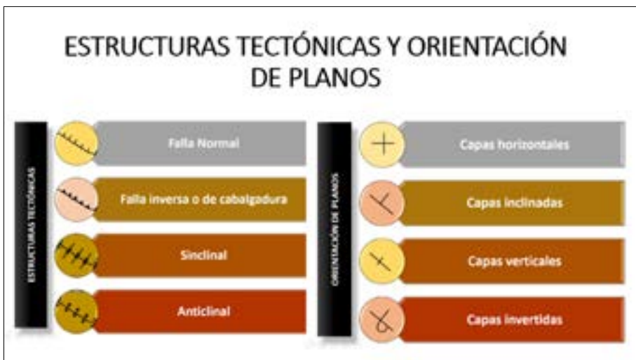
Figura 3. Simbología de orientación estructuras tectónicas y orientación de planos.
