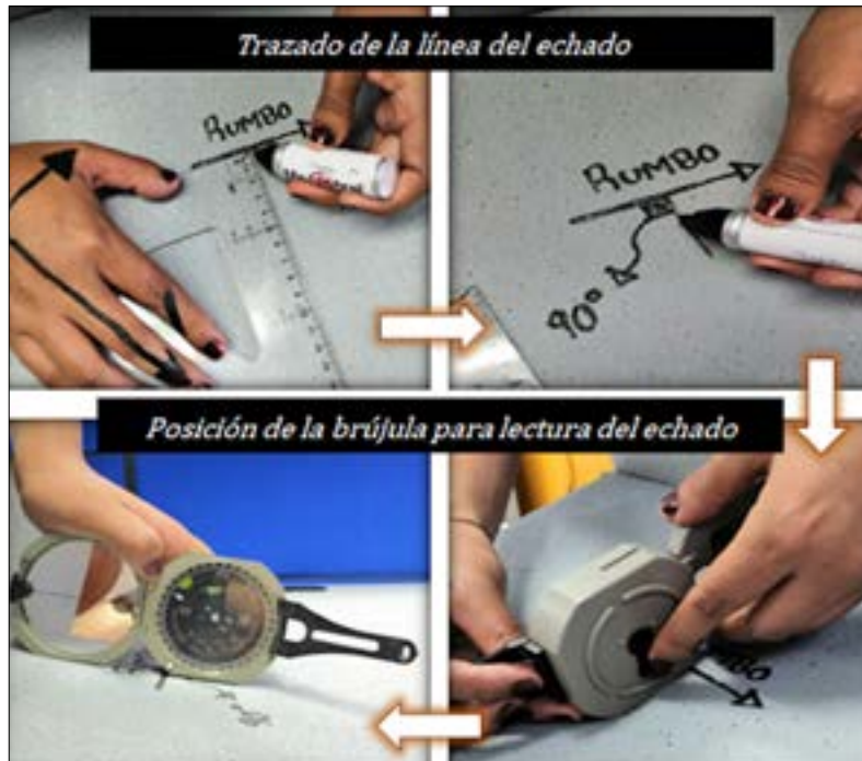
Figura 6. Proceso para la obtención del echado de un plano. Fuente: elaboración propia.
