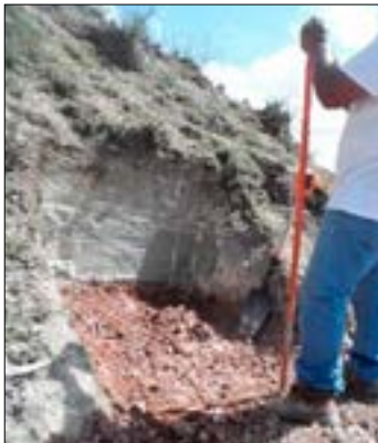
Figuras 3 y 4. Muestra de corte de perfil y pozo pedológico.
