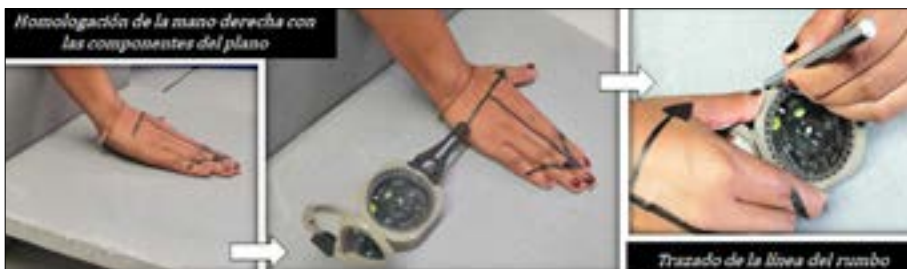
Figura 5. Proceso para la obtención del rumbo de un plano. Fuente: elaboración propia.
