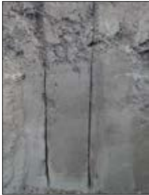
Figura 12. Marcar el contorno de la calicata con un cuchillo.
